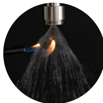
Flamme eines Feuerzeugs im Sog der Wirbelkammer
